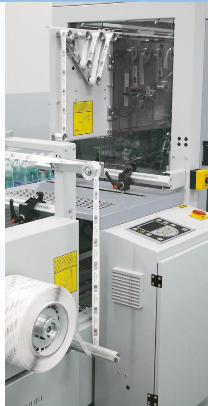
Eine andere wichtige Option für die Erhöhung der Flexibilität der Maschine ist die Vorrichtung "Lateral Transportriemen".
